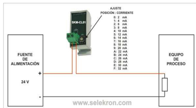
CONEXIÓN DEL MÓDULO SKM-CL01. EN SERIE ENTRE LA FUENTE DE ALIMENTACIÓN Y EL EQUIPO DE PROCESO
